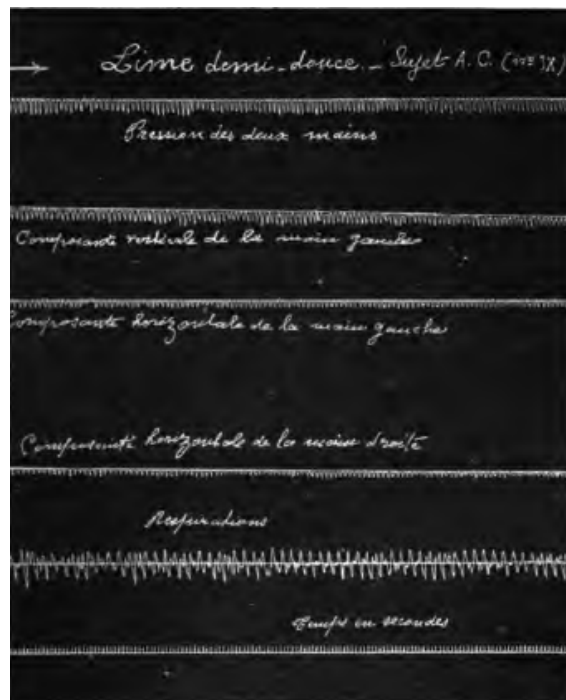
FIG. 25. — Graphique du travail d'un bon ouvrier limeur.
