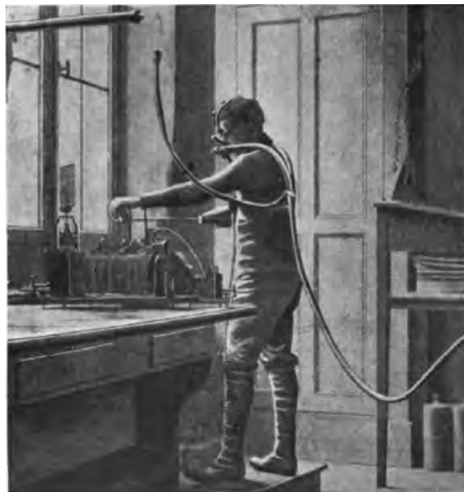
FIG. 45. — Travail d'un apprenti limeur et analyse de sa fatigue.
